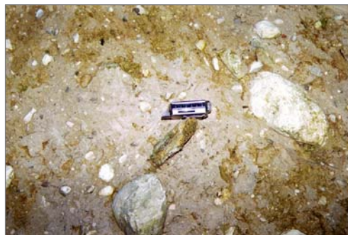
Figura 20: Deposito di fondo morenico si notano i clasti eterogenei per litologia e dimensione immersi in una matrice limosa.
