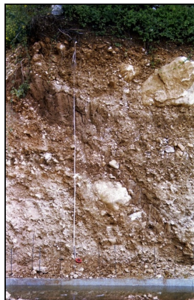
Figura 19: Depositi di deiezione torrentizia rinvenuti presso l'abitato di S. Donà. Si noti in particolare, la presenza, insieme ai detriti eterogenei, dei grossi massi indicativi di un episodio di trasporto di massa.
