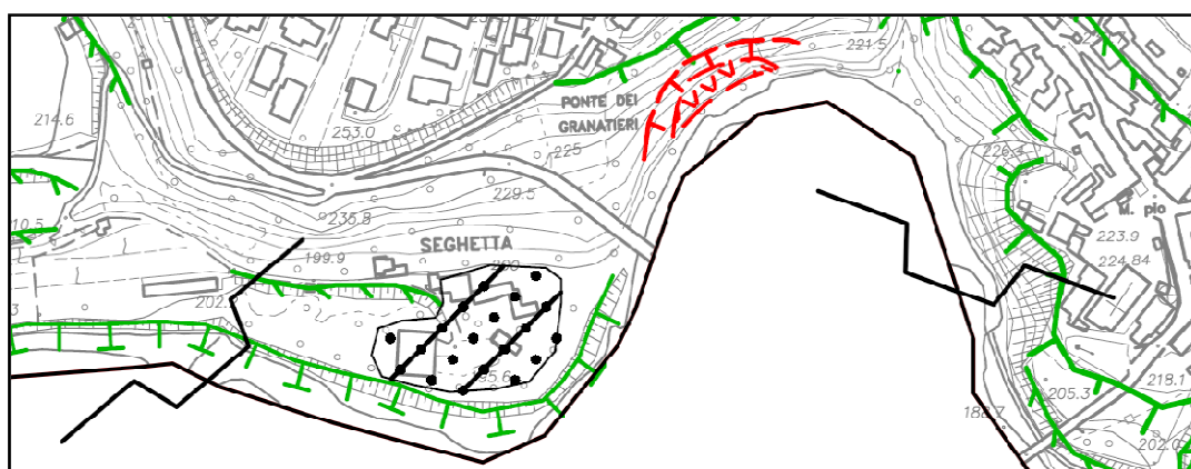
Figura 16: Terrapieno, briglie e frana di scorrimento presso il Ponte dei Granatieri lungo il T.Astico
