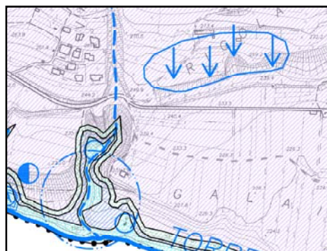
Figura 22: Area soggetta ad insorgenze idrica sotterranee in località Rigola e sorgente in località Galain
